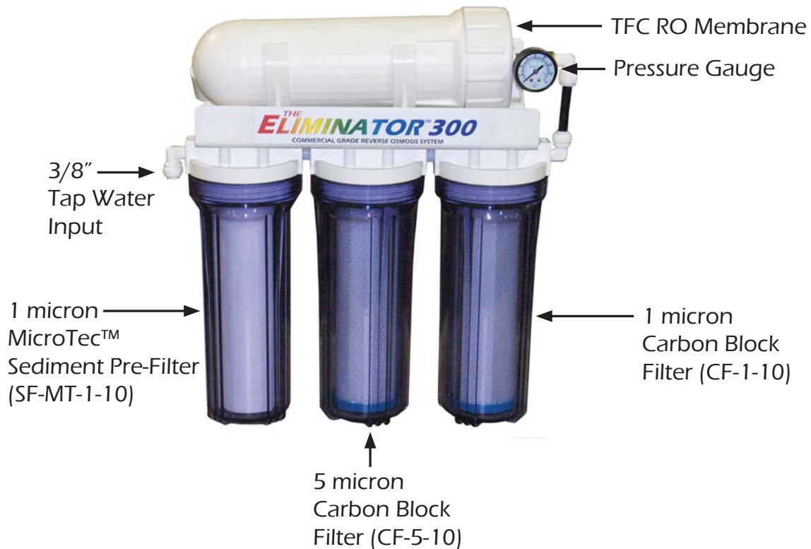
Fig. A: Single-Membrane Filter
